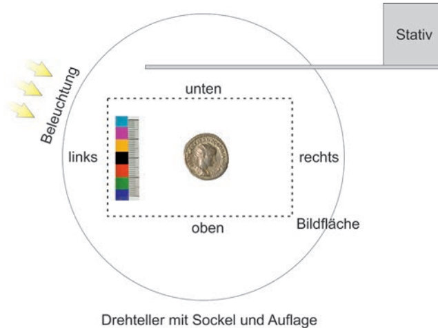
Abb. 7 Anordnung von Kamera und Beleuchtung
