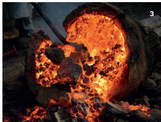
Abb. 1: Schlackenabstich am Rennofen, Abkühlung der Schlacke in einem Wassereimer. Foto: R. Reimann.
